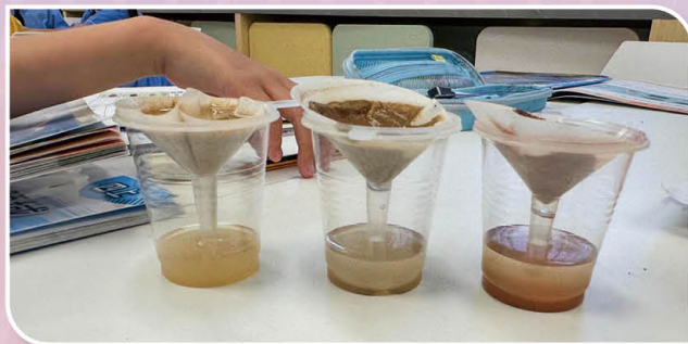
圖中四年級學生正在課堂上分組測試、觀察及記錄壤土、沙土及黏土的排水能力。
